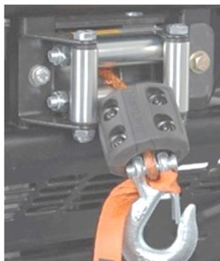
L'arrêteoir de treuil est conçu pour convenir à un câble synthétique ou en acier ayant jusqu'à 1/2 po de diamètre. **Remarque : Le retrait de certains accessoires du véhicule pourrait faciliter l'installation.**
